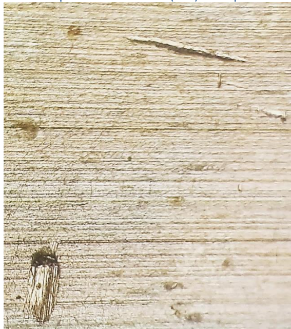
Inclusión de partículas metálicas (40X). Inaceptable
