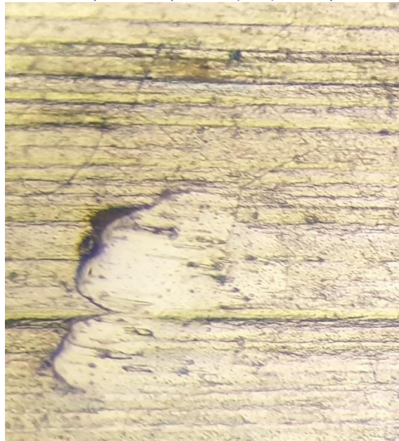
Inclusión de partículas metálicas (40X). Inaceptable
